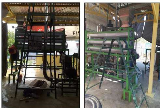
Gambar 3. Konstruksi pengumpan screw conveyor (SC) bertingkat
