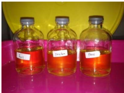
Gambar 3.2. Mikroemulsi W/O dengan proporsi air: surfaktan: minyak kelapa sebesar 1,3 : 5 : 15 dengan kelarutan ekstrak kulit jeruk terhadap fase air sebesar 1%.
